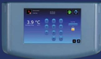
Es un control integrado, que restringe el acceso a los productos almacenados por medio de una cerradura electromagnética con usuarios configurados mediante asignación de contraseña, garantizando las temperaturas configuradas, controlando los tiempos de acceso y brindando uniformidad de temperatura de los productos almacenados. (disponible sólo en los Congeladores y Ultracongeladores)
